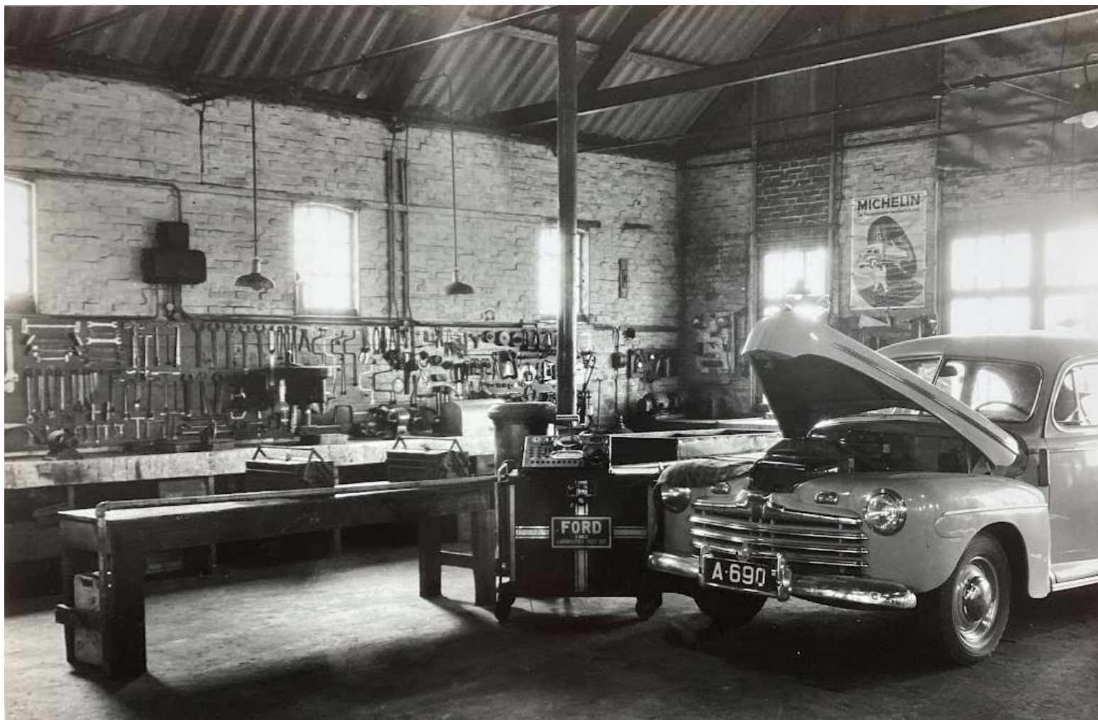
Interieur van de Ford werkplaats 1953. Ford V8 (1947) met origineel testapparaat. Nicolaas was vanaf 1924 officieel dealer van Ford automobielen, tractoren en vrachtwagens. De afdeling landbouwtractoren werd gerund door twee broers van hem in Ulrum, Roelof en Jan Bakker. Let ook op het gereedschap aan de wand. Wanneer je een stuk wegnam, bleef de tekening zichtbaar zodat je zag waar je het terug moest hangen na gebruik.
